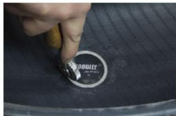
10、用压实滚轮由中心向外进行压实。
