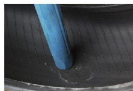
6、用吸尘器清除橡胶屑和钢丝屑。
