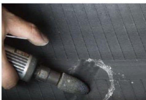
5、用低速打磨机和配套的打磨轮对所画区域进行打磨。最大转速不能大于5000转/分。（橡胶清洗剂不可代替打磨作业）
