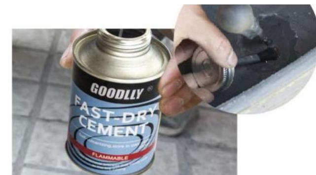
7、在中心线的打磨部位涂上化学硫化机。等待3-5分钟的干燥时间。当天气潮湿或寒冷时，要延长干燥时间。
