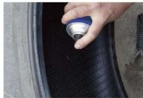
3、用橡胶清洗剂中间线部分，趁清洗剂未干燥前用挂垢具刮掉异物。重复该动作2-3次。
