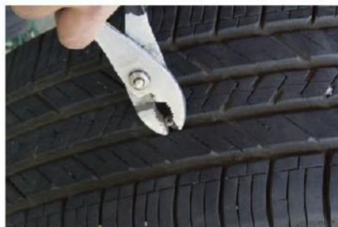
2、取出引起穿透的异物，检查轮胎破损情况。
