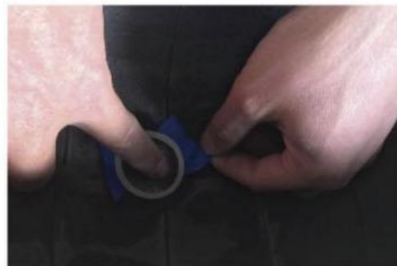
9、取掉整体塞背面的透明薄膜。
